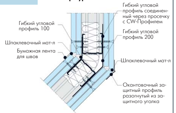
W112-D2 Образование угла с гибким угловым профилем
